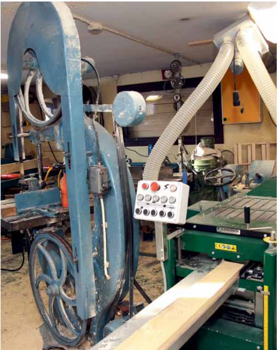
Une scie à ruban centenaire, autrefois entraînée par courroie, aujourd'hui animée par un moteur électrique, à côté d'une Logosol PH260.
