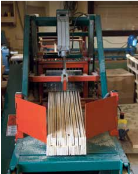
À peine huit millimètres : c'est l'épaisseur des planches sciées avec de faibles pertes en sciures et des cotes parfaites
