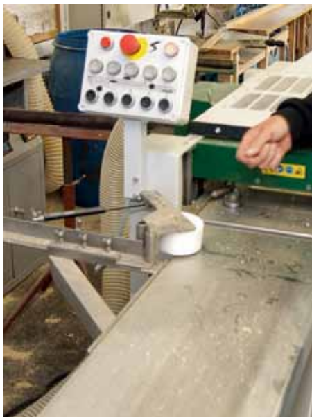
Un rouleau support ingénieux à l'extérieur du rabot guide le bois à travers la machine.
