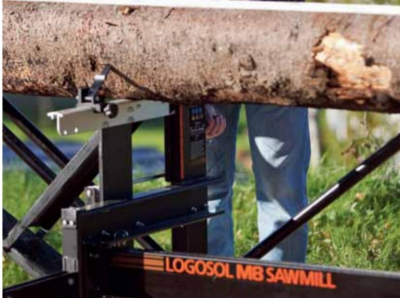
• Les grumes sont soulevées à l'aide de treuils jusqu'à la hauteur de travail confortable, et sont maintenues en place par de puissantes griffes de serrage.
